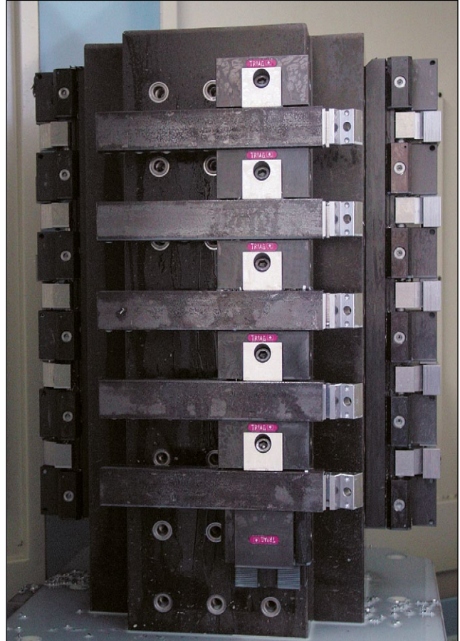
7 Aufspannung mit Power Clamp auf einem „Triproxy“ Mineralgussturm Set up with Power Clamp on a tombstone made of composite concrete Serrage Power Clamp sur une tourelle à minérale coulée
