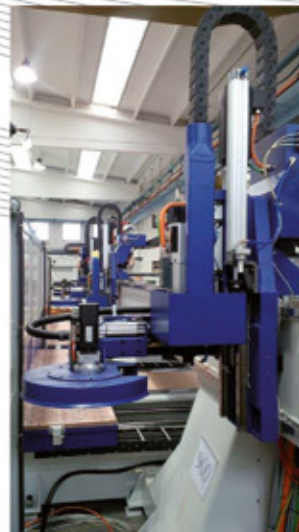
6-position tool change Cambio utensile a 6 posizioni
