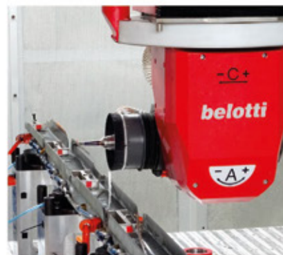
Motorized dust suction hood Cuffia d'aspirazione motorizzata
