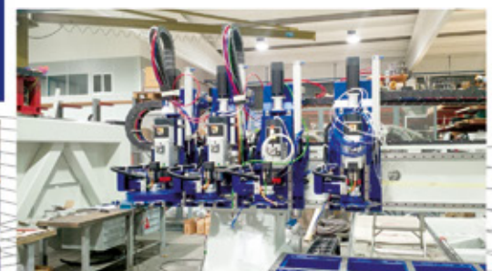
Independent 4 heads structure with tool change Struttura a 4 teste indipendenti con cambio utensile
