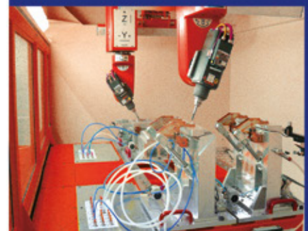
Double independent bridge for parallel machining Doppio ponte indipendente per processi paralleli
